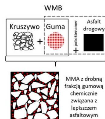
Rys. 3. Schemat technologii modyfikacji mieszanki mineralno-asfaltowej granulatem gumowym z dodatkiem polioktenameru
