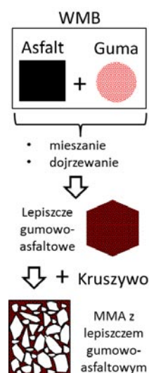
Rys. 2. Schemat technologii wet process (na mokro)
